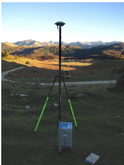
Photographie du microgravimètre lors d'une station de mesure
