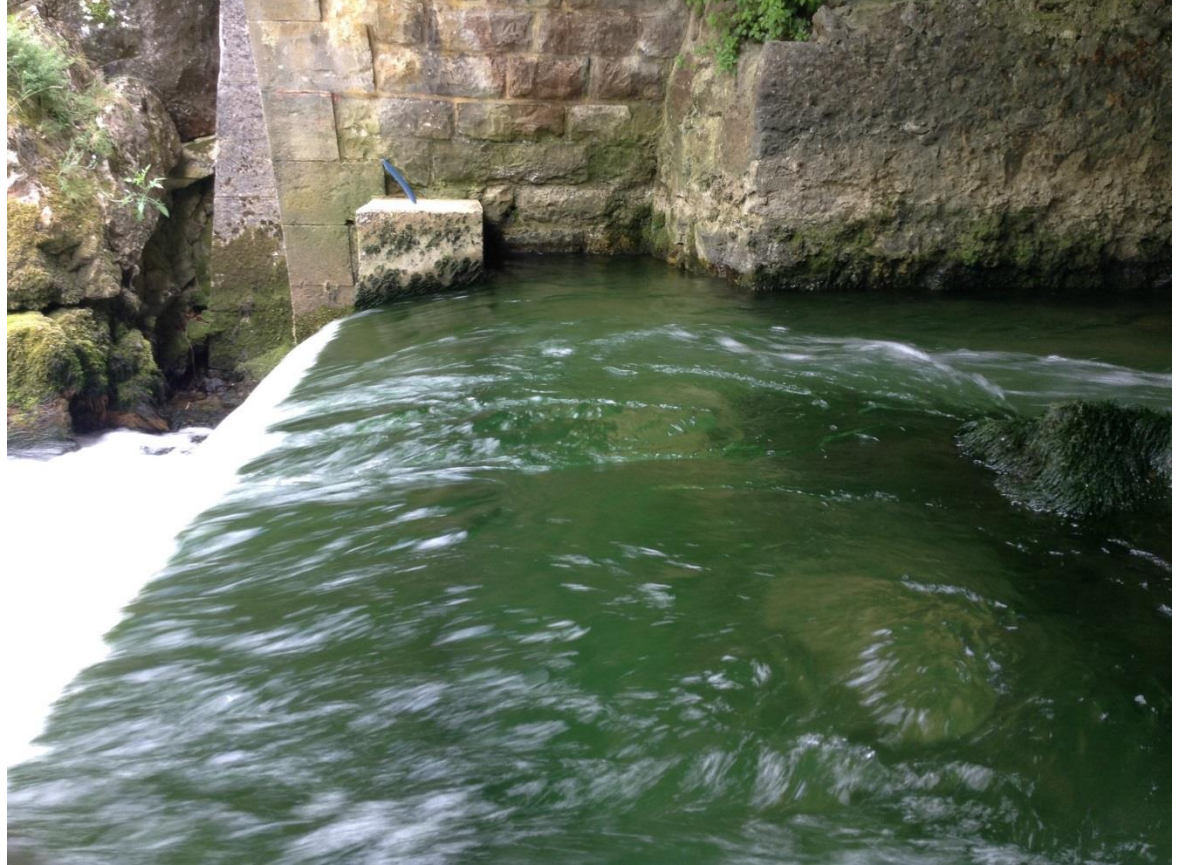
Arrivée du traceur uranique colorant la source de FontMaure (Photographie prise le 15 mai 2015 © Fabien Levard)
